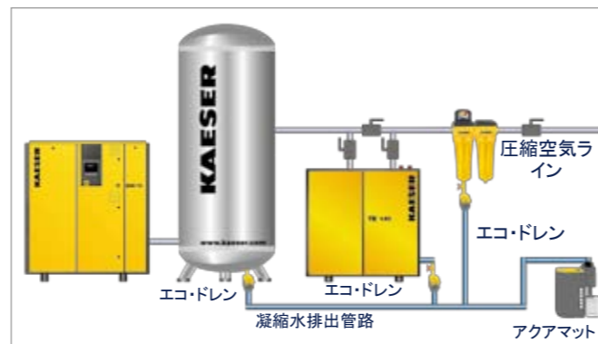
全ての収集箇所に、確実な凝縮水排出方法で取り付けする必要があります。最良の結果は、電子制御の凝縮水排出装置を使うことで達成できます。
