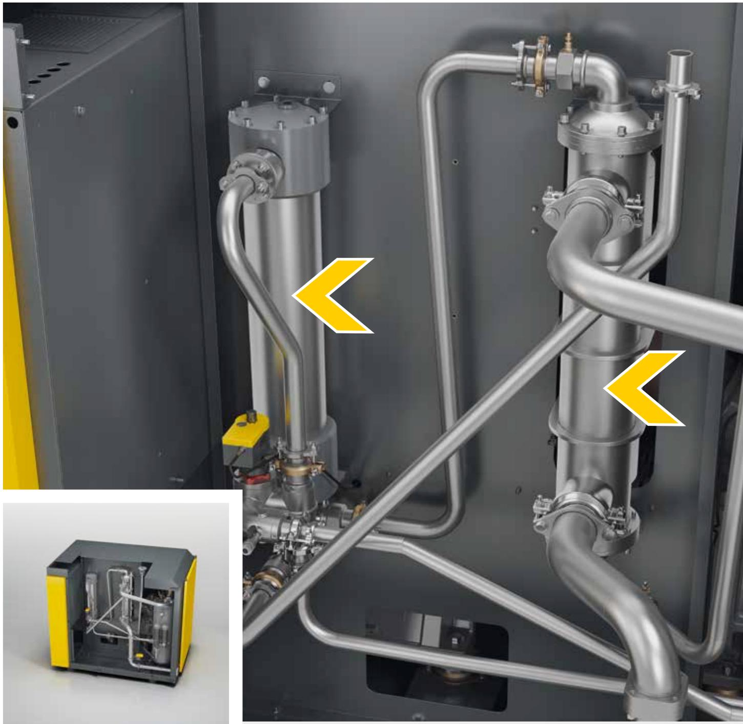
プレート型熱交換器は最適の冷却能力を備えますが、銅ニッケル合金(CuNi10Fe)のシェル／チューブ式熱交換器は汚れにくく、堅牢性が高く、機械的に洗浄できます。クーラー挿入部は、とても簡単に交換できます。
