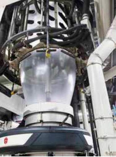
左の画像:巨大なフォイルシートがこれらのタワー型押し出し成形機内で生産されています。右の画像:これらの新しい圧縮空気ステーションは、スペースを節約するために2段に配置されています。
