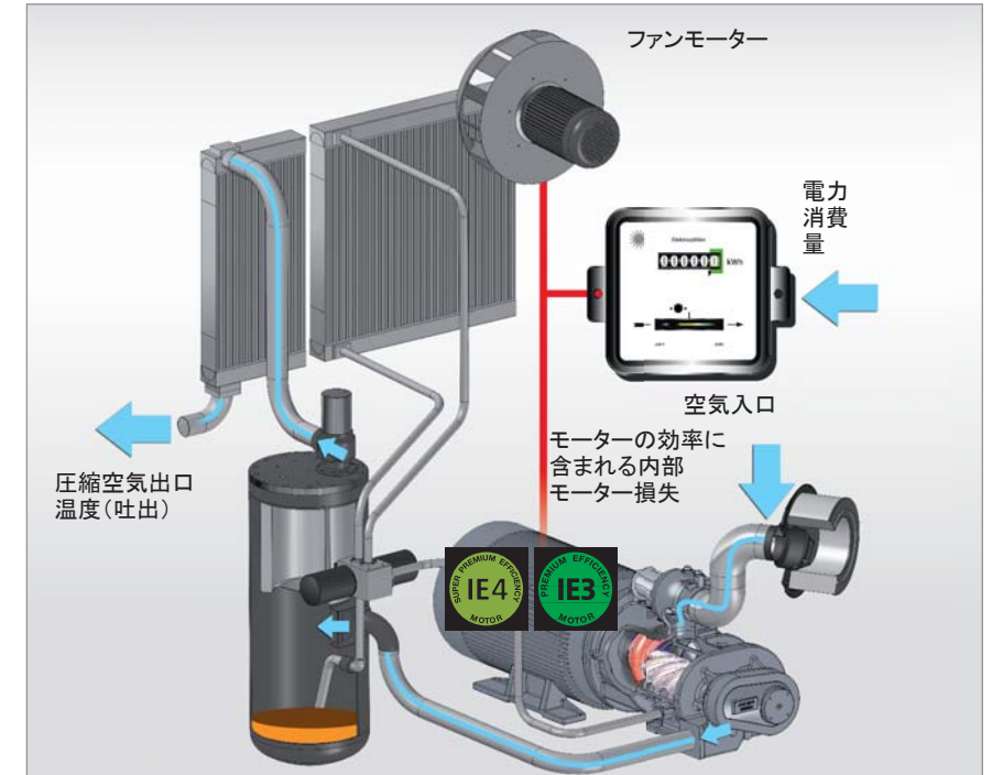
図2: スクリューコンプレッサの基本的なレイアウト。比出力の判断
