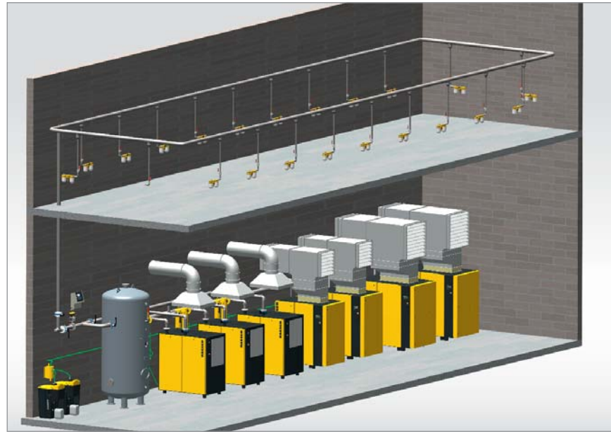
排気システムと冷凍式ドライヤー用の追加のサーモスタット制御換気システムを備えた圧縮空気ステーションの例
