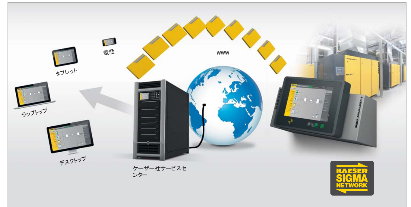
図7: 広範なマスターコントローラー接続性。圧縮空気ステーションのエネルギー効率の高い運転を大幅に強化
