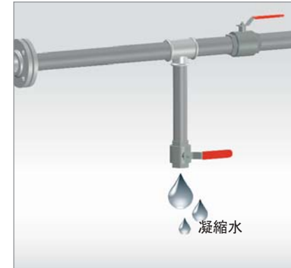
図7: 圧縮空気分岐配管で水分をチェック
