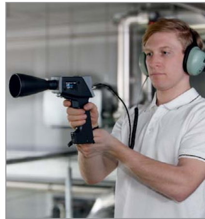
図4: 超音波を使用して漏れ位置の特定
