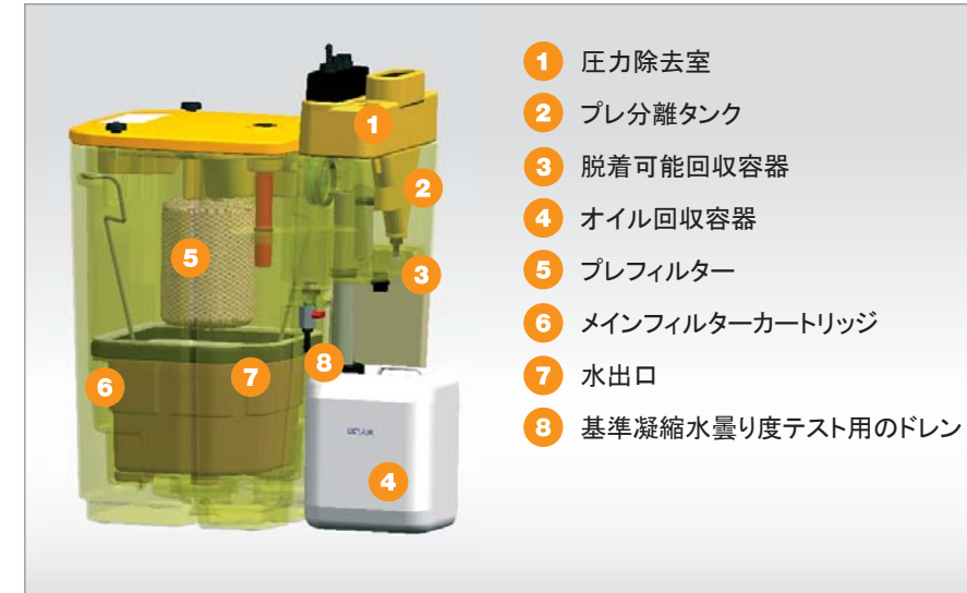
図2: 重力の原理を使用した圧縮空気技術用凝縮水分離システム(機能図)
