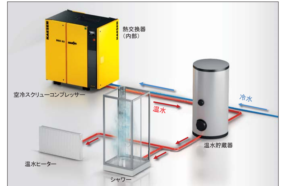
図3: 熱回収プロセス
